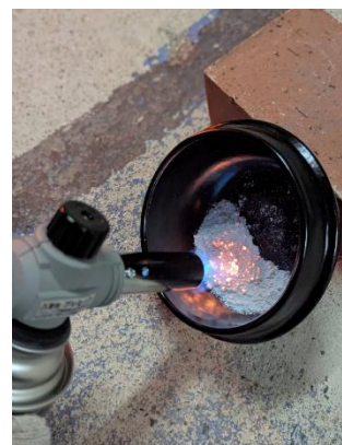
図3 ガスバーナーで加熱する牡蠣殻粉末
