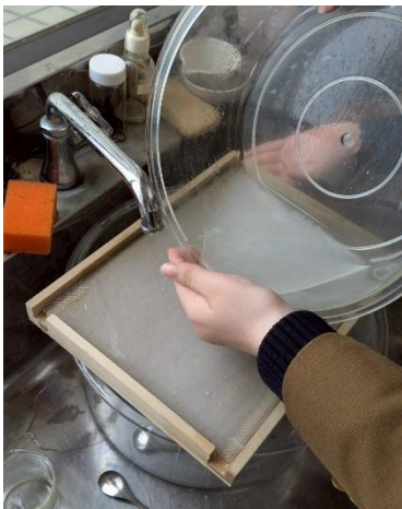
図 3 二層目の原料を紙すきに流す
